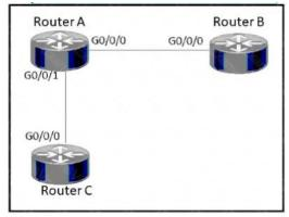
Router A (config)#cdp run Router A (config)#interface gi0/0/0 Router A (config-if)#no cdp enable
